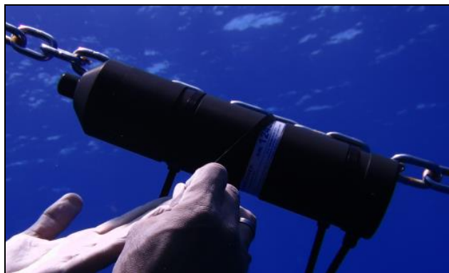
Figuras 1. Receptor passivo VR2W da Vemco, utilizado no presente estudo.
